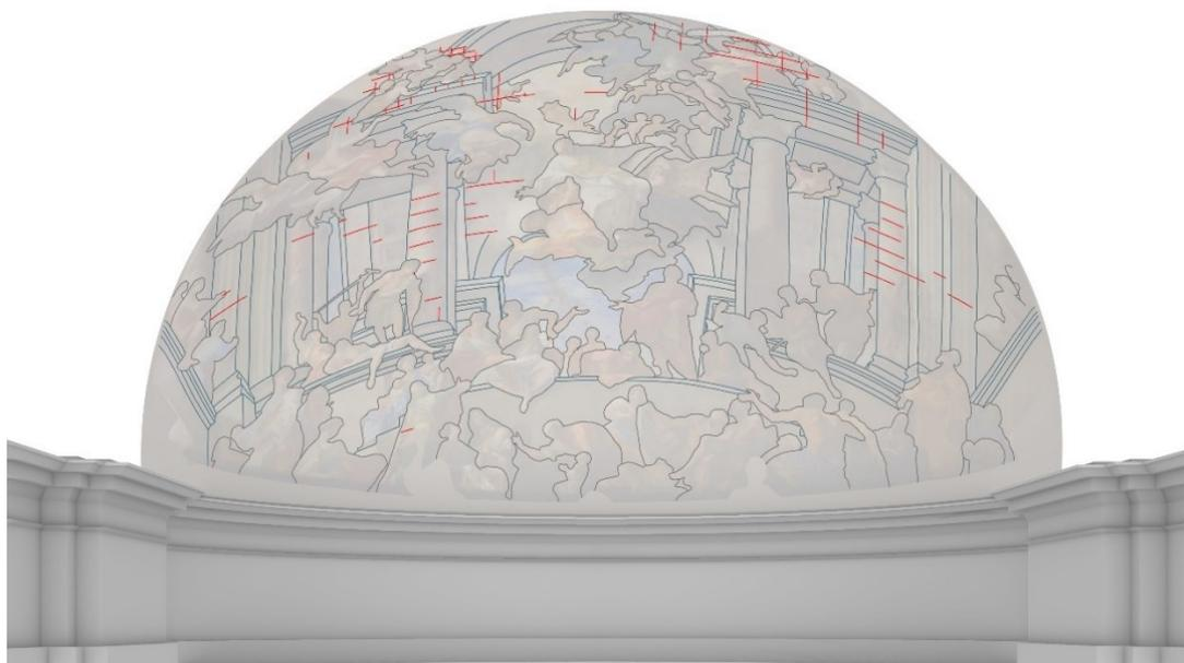
Fig. 61. Catino absidale: restituzione al tratto degli elementi architettonici, figurativi e dei segni della graticola.
